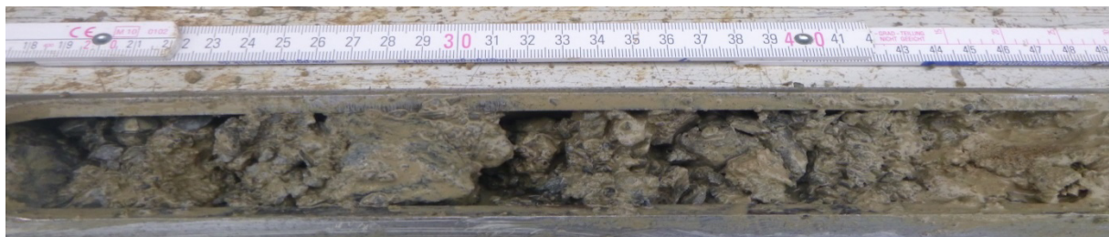
Bild 4: Tragschicht aus Kalksteinschotter und Sand, RKS 4
