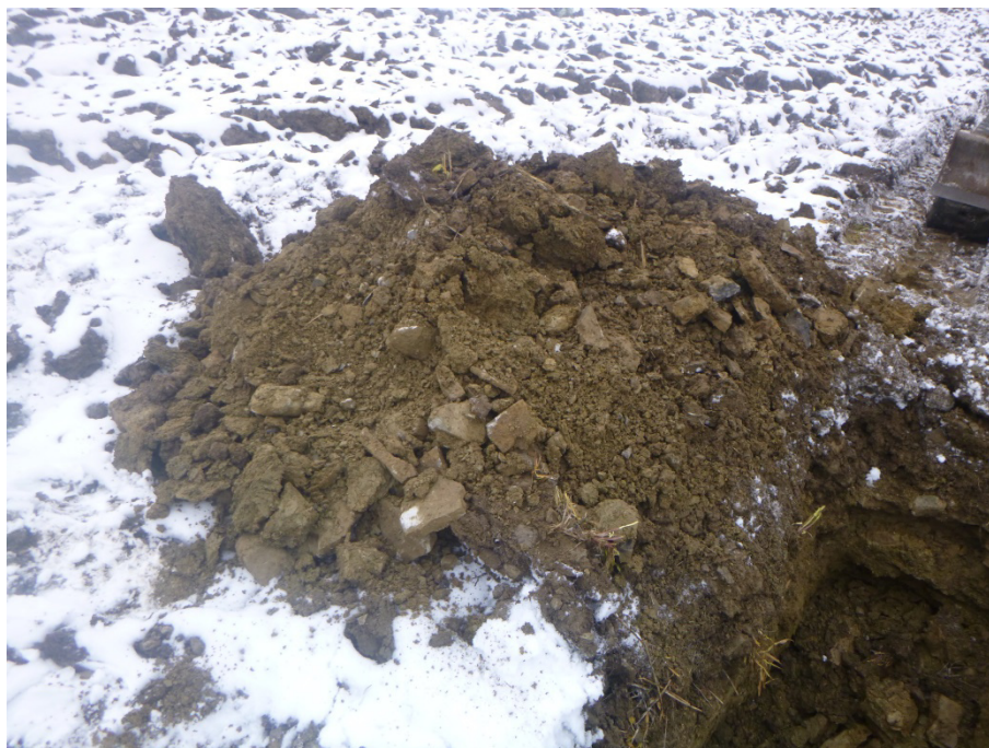
Bild 6: Verwitterungsschutt aus Kalkstein mit Lehmantteilen (SCH 1)
