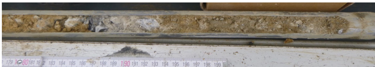
Bild 5: Verwitterungslehm mit Kalksteingeröllschutt mit Lehmanteilen (RKS 3)
