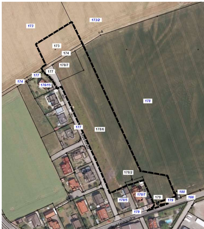
Abb. 3: Kataster und Luftbild; schwarz - Flurstücknummern im Geltungsbereich; blau - an den Geltungsbereich angrenzende Flurstücknummern (Kartengrundlage: Bayerische Vermessungsverwaltung)
